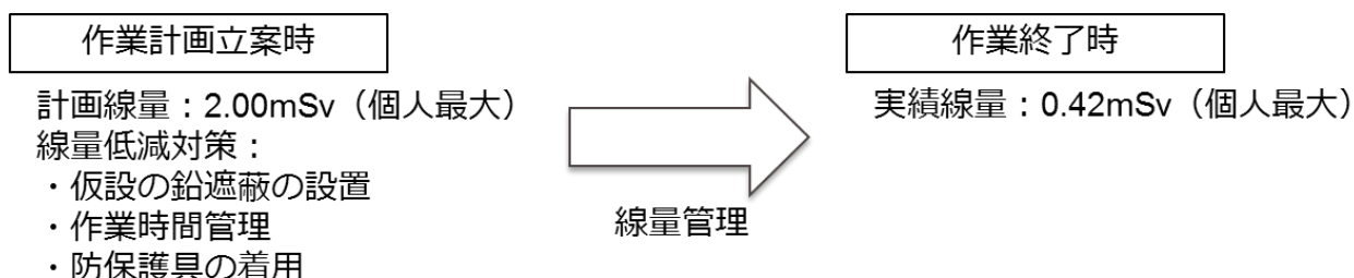
第11図 RCPインターナル除染作業での実績（例）
