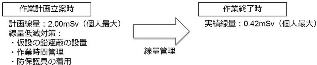
第9図 RCPインターナル除染作業での実績（例）
