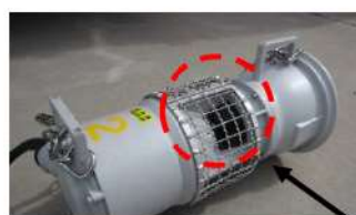
①水中ポンプの吸込み部
