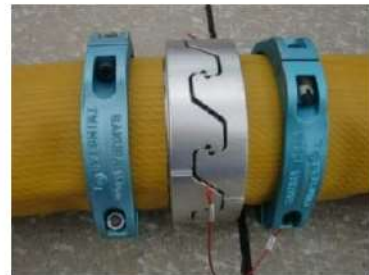
可搬型ホース（150A）接続後
