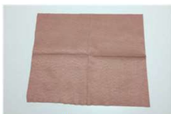
吸着布 （フーリンアンブール類縁体を吸着剤として担持した布）
