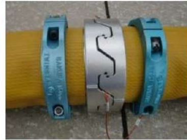
可搬型ホース（150A）接続後
