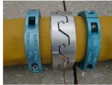
可搬型ホース（150A）接続後
