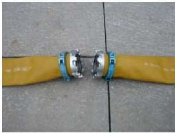
可搬型ホース（150A）接続前
