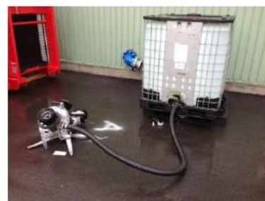
小型放水砲及び泡消火薬剤
