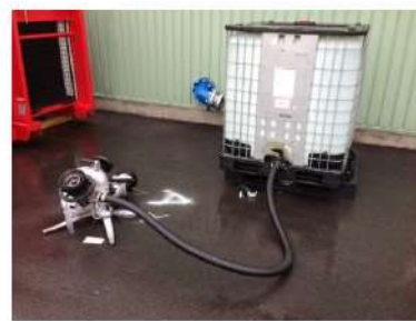
小型放水砲及び泡消火薬剤
