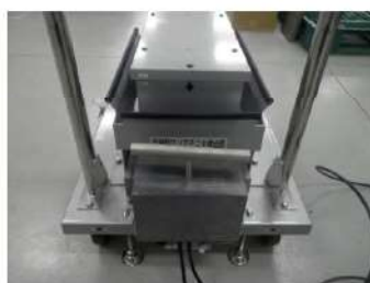
可搬型エリアモニタ 検出器側
