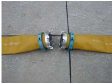
可搬型ホース(150A)接続前
