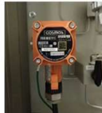
図3 可搬型格納容器内水素濃度計測ユニット検出器
