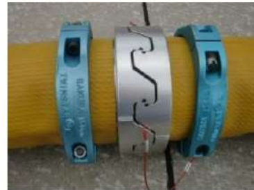
可搬型ホース(150A)接続後
