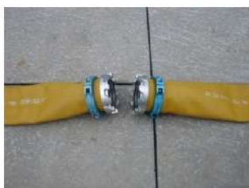
可搬型ホース(150A)接続前
