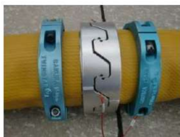
可搬型ホース(150A)接続後
