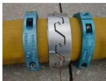
可搬型ホース(150A)接続後
