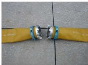
可搬型ホース（150A）接続前
