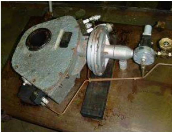
蒸気暴露試験後
