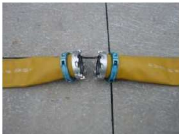
可搬型ホース (150A) 接続前
