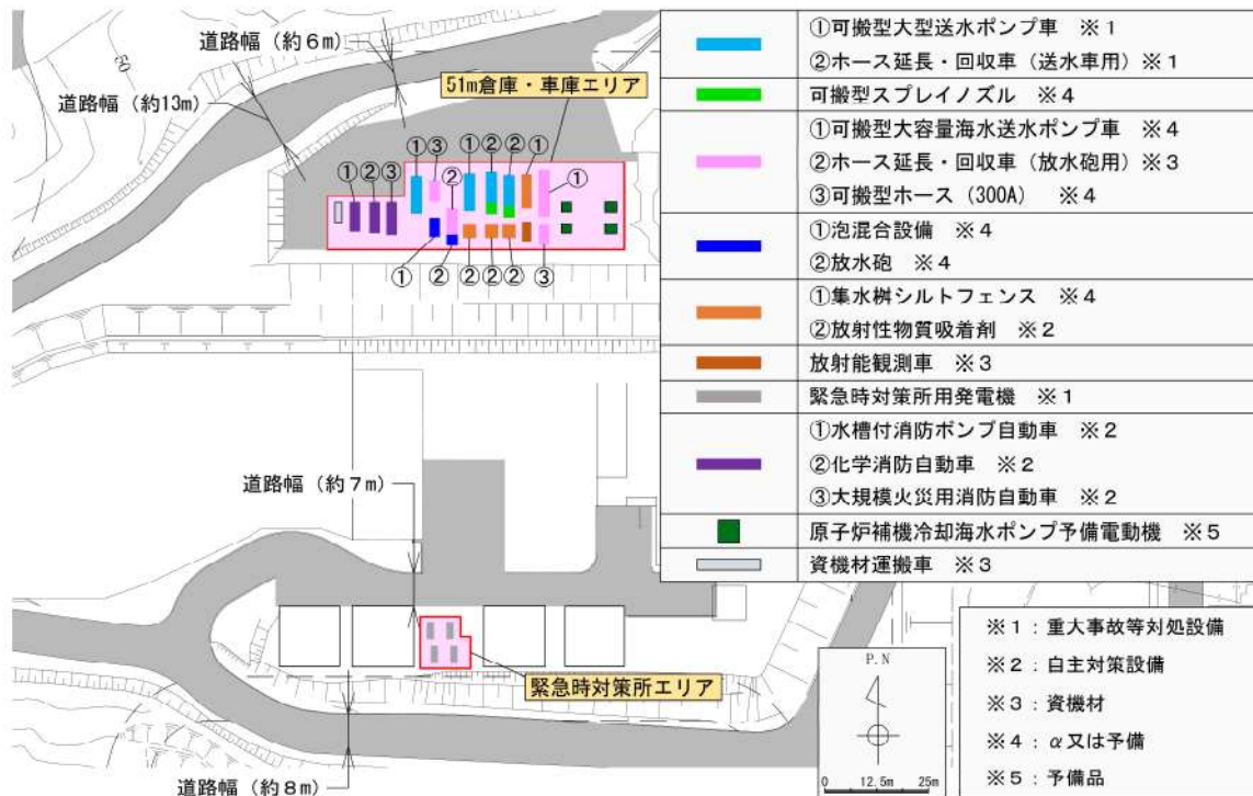
第 2 図 保管場所の可搬型設備配置 (1/3)
