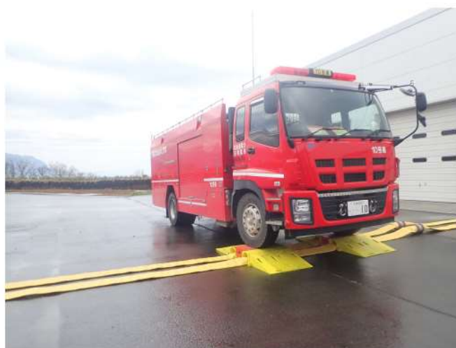
第1図 ホースブリッジの設置状況
