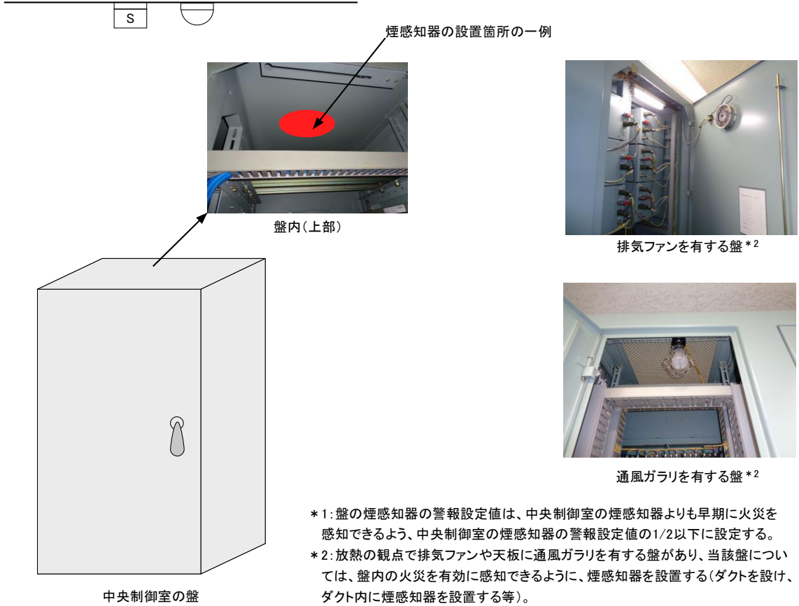
第 2.1 図 中央制御室の盤に対する煙感知器の設置イメージ
