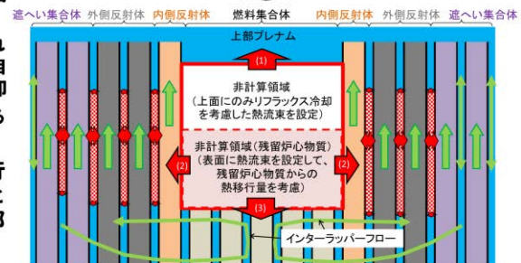
FLUENTによる残留炉心物質周辺の熱移行現象のモデル化概念図
