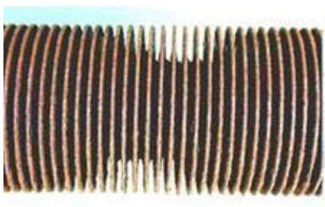
第2図 過去の主冷却器伝熱管の肉厚確認結果 (一例)
