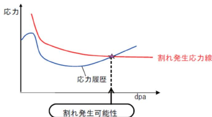
図1 割れ発生予測評価概念図
