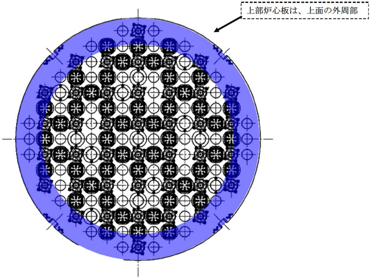
図 4-3 炉内構造物可視範囲概略図（上部炉心板組立図）
