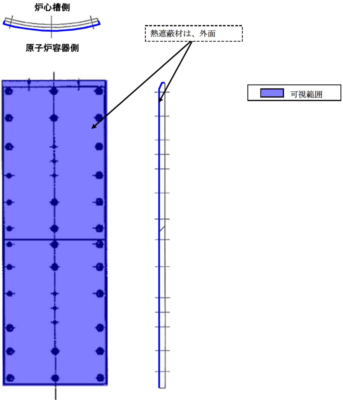
図 4-6 炉内構造物可視範囲概略図 (熱遮蔽材組立図)
