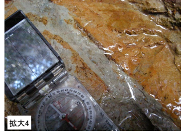
● 泥岩中の断層面の連続性はやや不明瞭で平面性は低い。また幅約5mmの砂礫岩を挟んでいるが、粘土状破碎部を伴わない。 ● 砂礫岩は、周囲の砂岩層と同様の固結の程度である。
