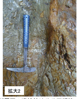
● 砂岩と泥岩の境界の断層面の連続性はやや不明瞭でしばしば分岐し、平面性は低い。また幅約5mmの砂礫岩を挟んでいるが、粘土状破碎部を伴わない。 ● 砂礫岩は、周囲の砂岩層と同様の固結の程度である。
