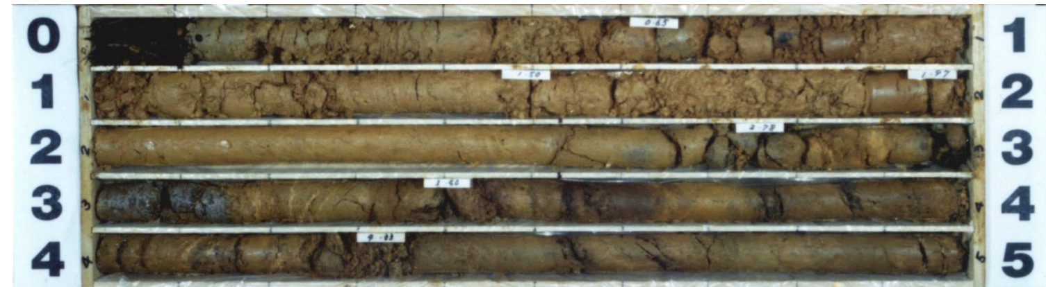
コア写真(C-13孔 0.0~5.0m 掘進傾斜鉛直)
