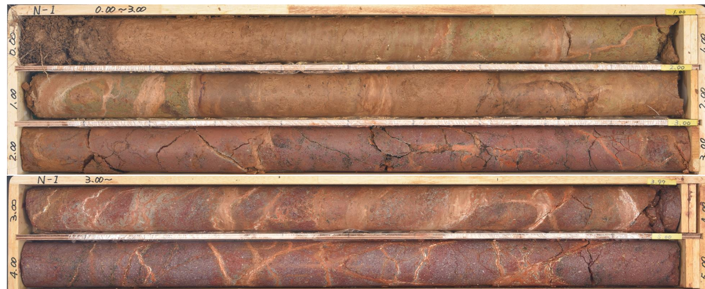
コア写真(0.0~5.0m, 掘進傾斜鉛直)
