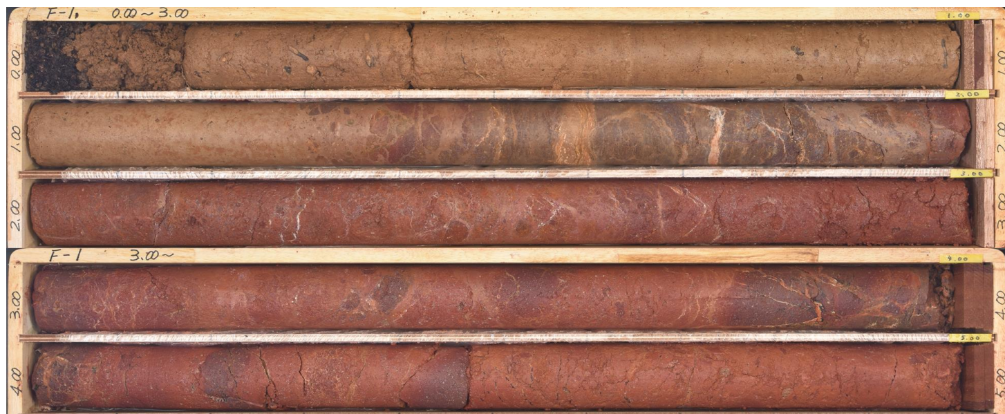
コア写真(0.0~5.0m, 掘進傾斜鉛直)
