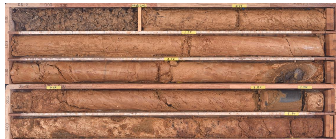
OS-2孔コア写真(0.0~5.0m, 掘進傾斜45°)
