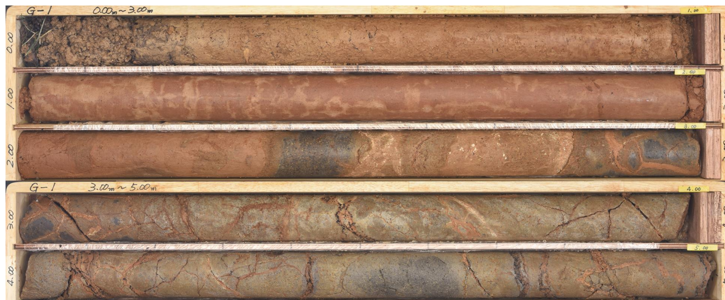
コア写真(0.0~5.0m, 掘進傾斜鉛直)
