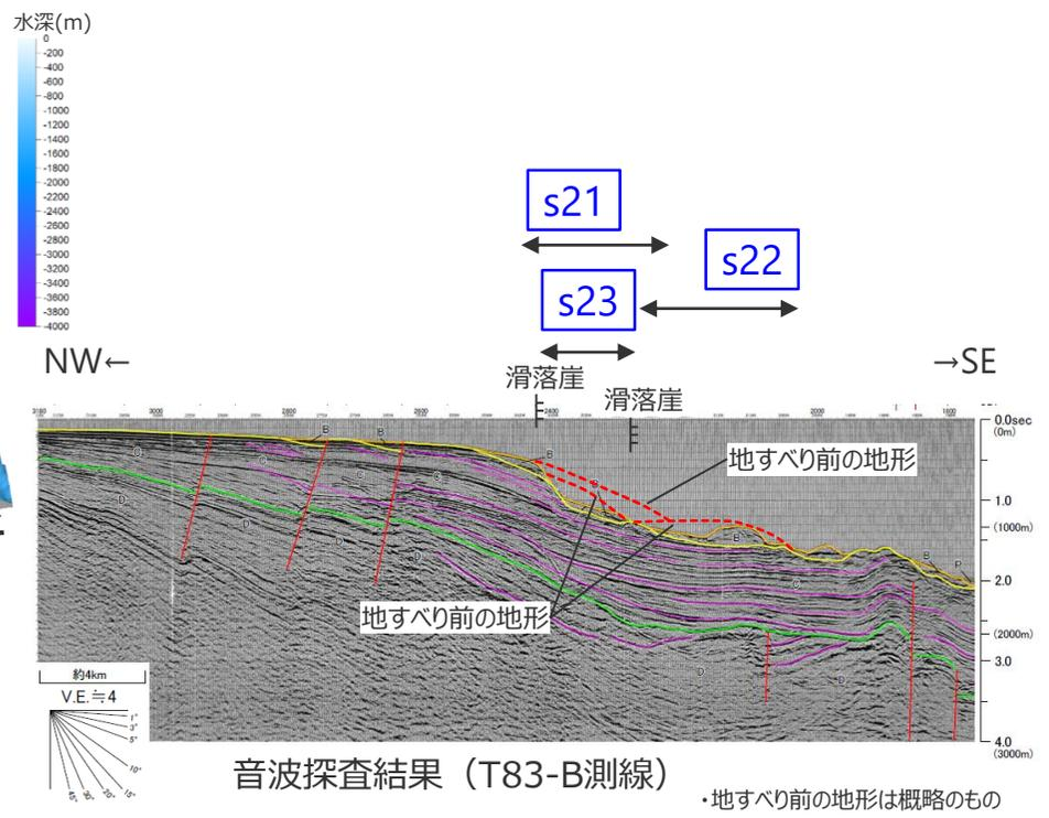
音波探査結果 (T83-B測線)
