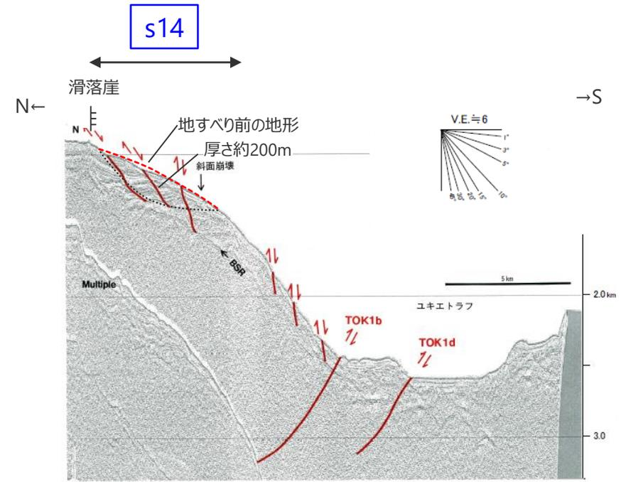
音波探査結果 (A断面) (東海沖海底活断層研究会(1999)に基づき作成)
