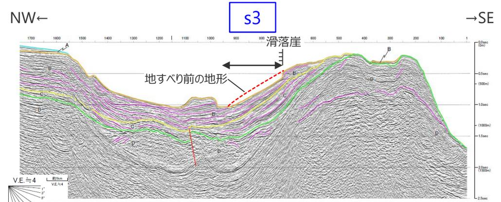
音波探査結果 (A11測線)
