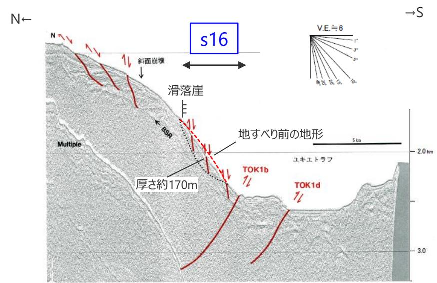
音波探査結果 (A断面)
