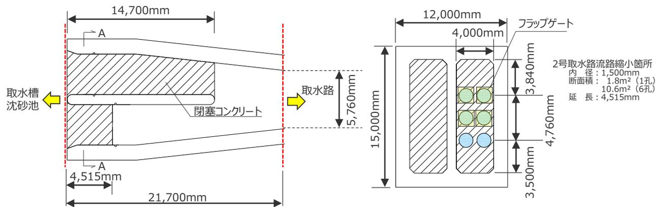
1号取水路出口流路縮小箇所 平面図・A-A断面図
