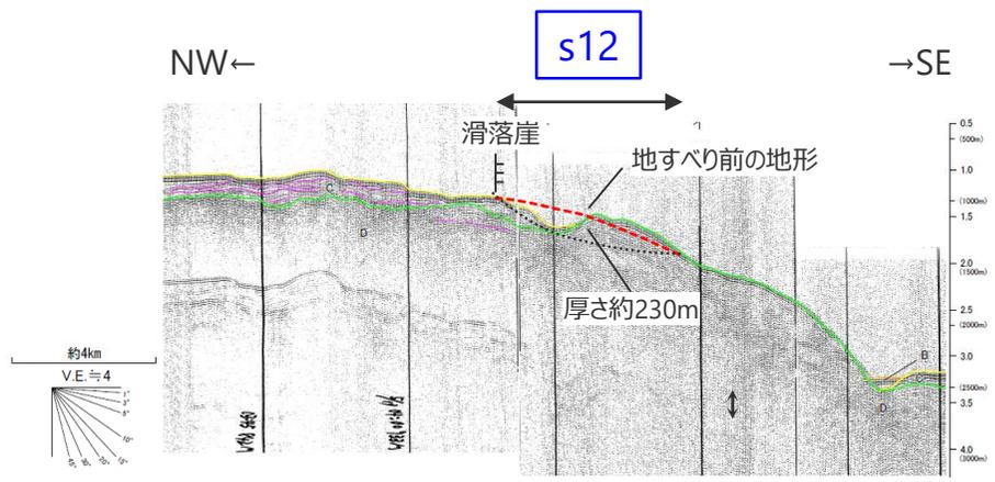
音波探査結果 (GA46測線) ..... すべり面
