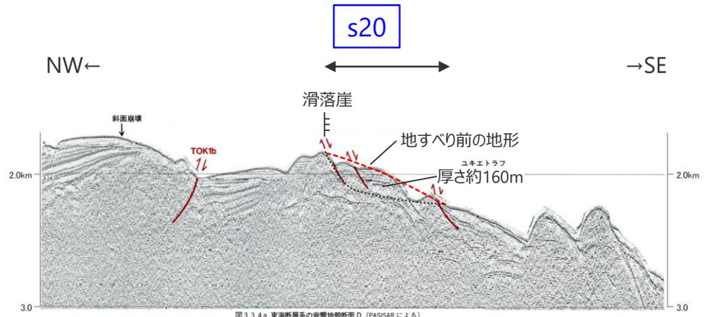
音波探査結果(D断面)
