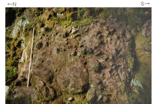
露頭写真⑤(近景) 凝灰角礫岩からなる スケールは1m
