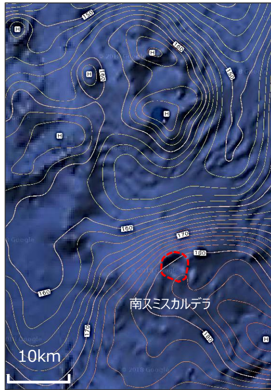
(産業技術総合研究所 地質図Naviを基に作成) 南スミスカルデラ周辺 地形図+ブーゲー異常図
