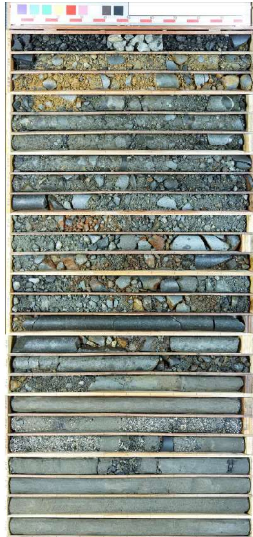
添付 1-9 図(1/3) ボーリング柱状図・コア写真 (RE-6)
