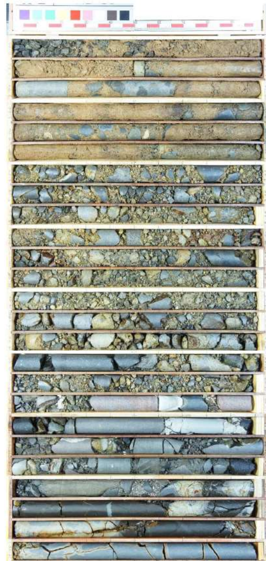
添付 1-29 図(1/2) ボーリング柱状図・コア写真 (RE-8)
