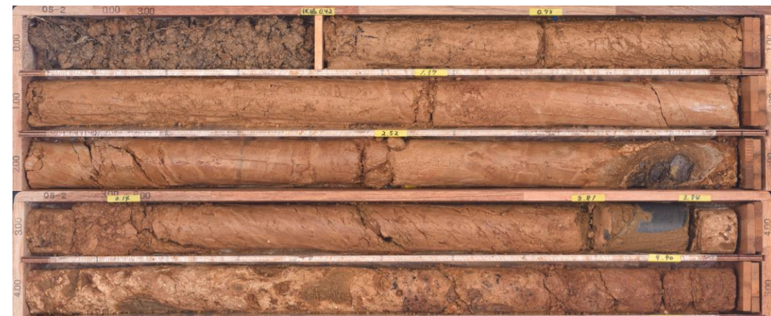
OS-2孔コア写真(0.0～5.0m, 掘進傾斜45°)
