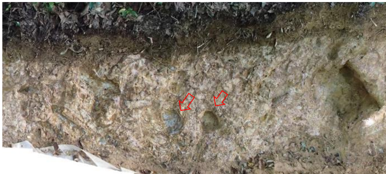
写真⑧ 中央部拡大 基質と色調が異なる礫を赤矢印で示す。
