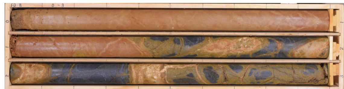
FD-8孔コア写真(0.0~3.0m, 掘進傾斜45°)
