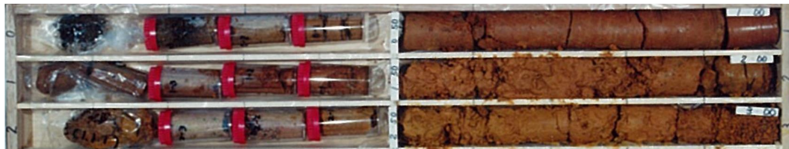
コア写真(0.0~3.0m, 掘進傾斜鉛直)
