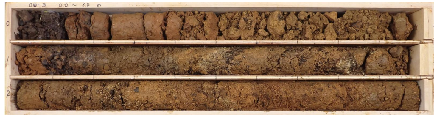
コア写真(0.0~3.0m, 掘進傾斜鉛直)
