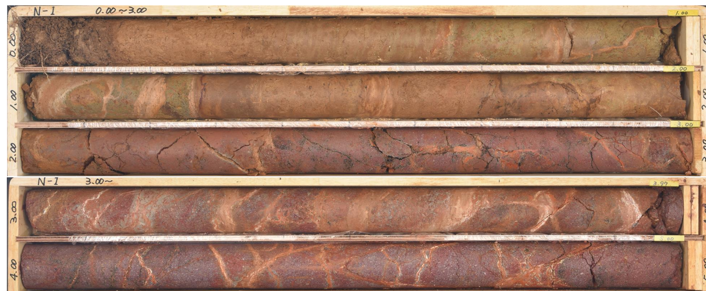
コア写真(0.0~5.0m, 掘進傾斜鉛直)
