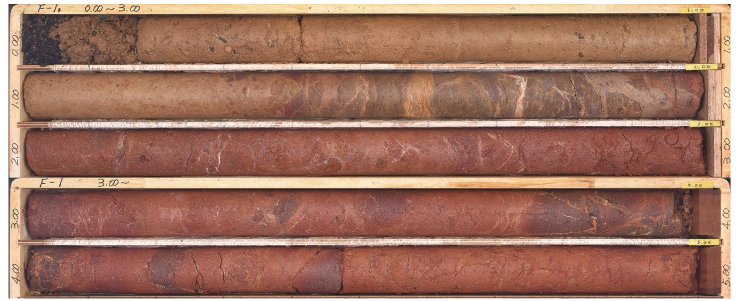
コア写真(0.0~5.0m, 掘進傾斜鉛直)
