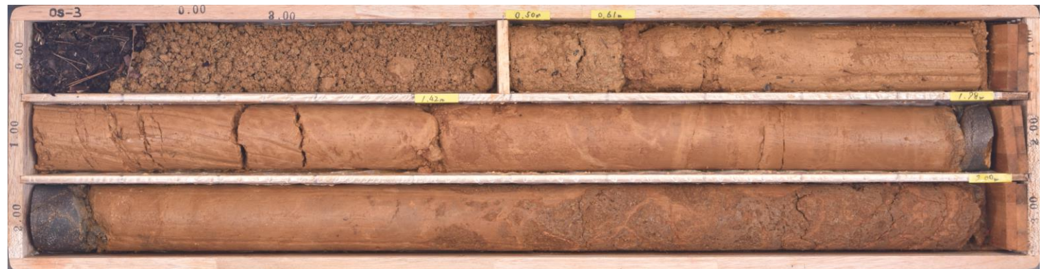
OS-3孔コア写真(0.0~3.0m, 掘進傾斜45°)
