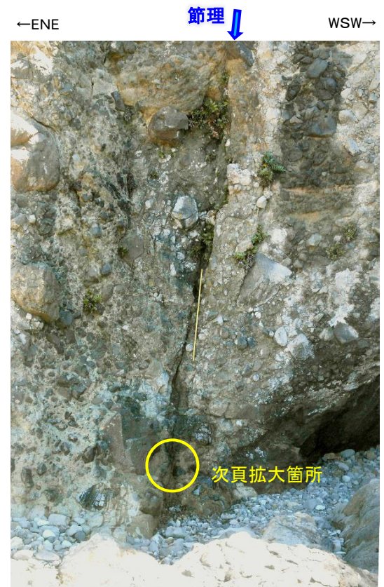
写真① 谷地形(2)と走向が調和的な連続性のよい節理
