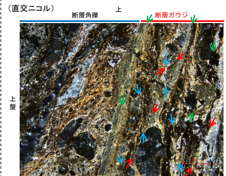
せん断センスを示す複合面構造 (狩野・村田 (1998)に加筆)
