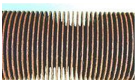
第2図 過去の主冷却器伝熱管の肉厚確認結果（一例）
