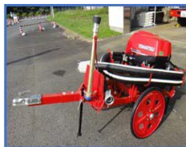
[可搬型消防ポンプ]
