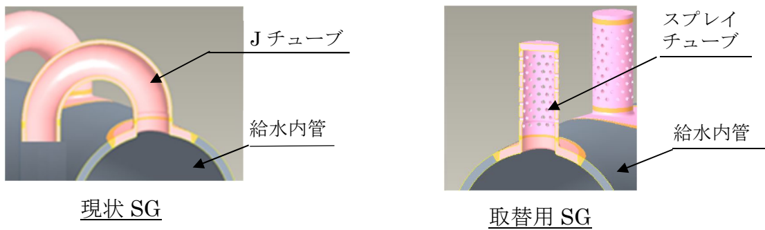
(c) 給水内管給水口
