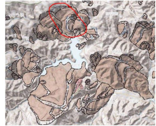
図5 再判読した荒砥沢ダム周辺の地すべり地形分布図と荒砥沢地すべりの変動範囲 (赤線の範囲)
