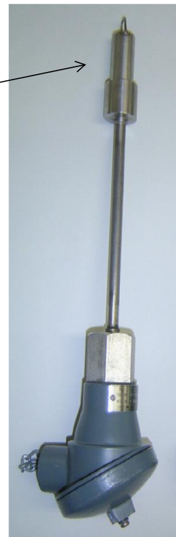
第1図 接点式ナトリウム漏えい検出器の構造
