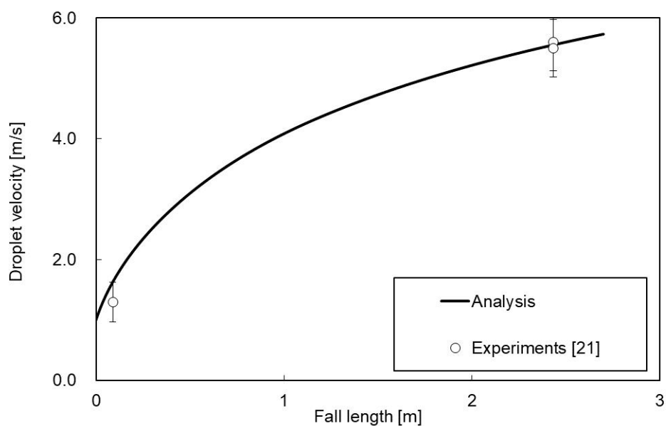
第 4 図 液滴落下速度の比較（単一液滴燃焼実験、化学反応モデル：B I S H O P）
