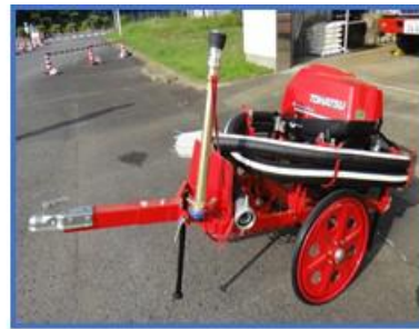
[可搬型消防ポンプ]
