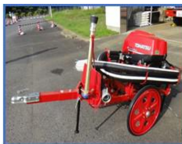
[可搬型消防ポンプ]
