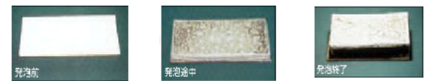
加熱前 200~250℃で発泡し断熱層を形成 発泡完了
