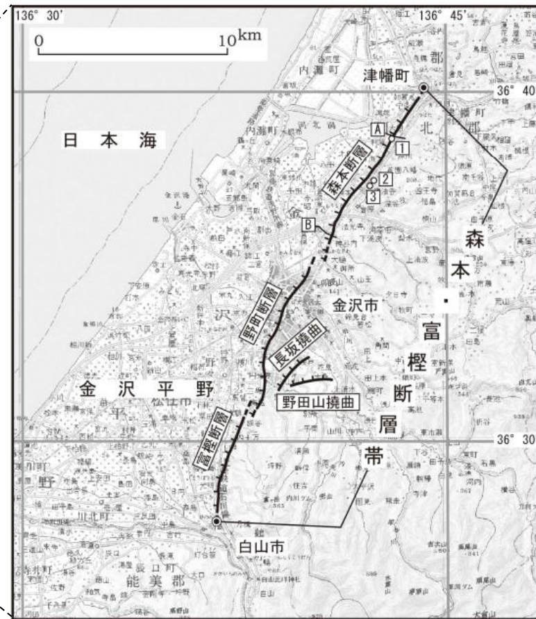
図 2 森本・富樫断層帯の活断層位置と主な調査地点 1: 利屋地点 2: 梅田北地点 3: 梅田南地点 A, B: 反射法弾性波探査測線 ●: 断層帯の北端と南端 活断層の位置は東郷ほか(1998a, b)及び東郷(2000)に基づく。 基図は国土地理院の「数値地図 200000 (地図画像)」「七尾」及び「金沢」を使用。
