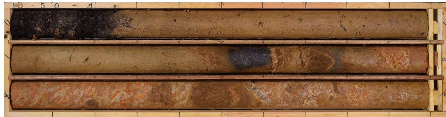
FD-5孔コア写真(0.0~3.0m, 掘進傾斜45°)
