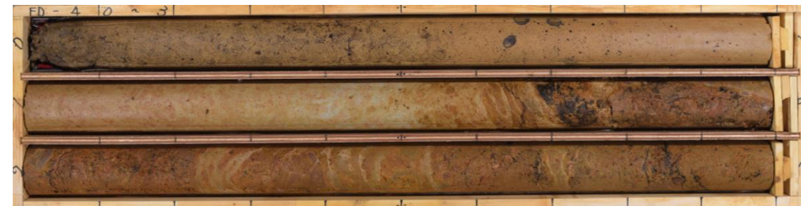
FD-4孔コア写真(0.0~3.0m, 掘進傾斜45°)
