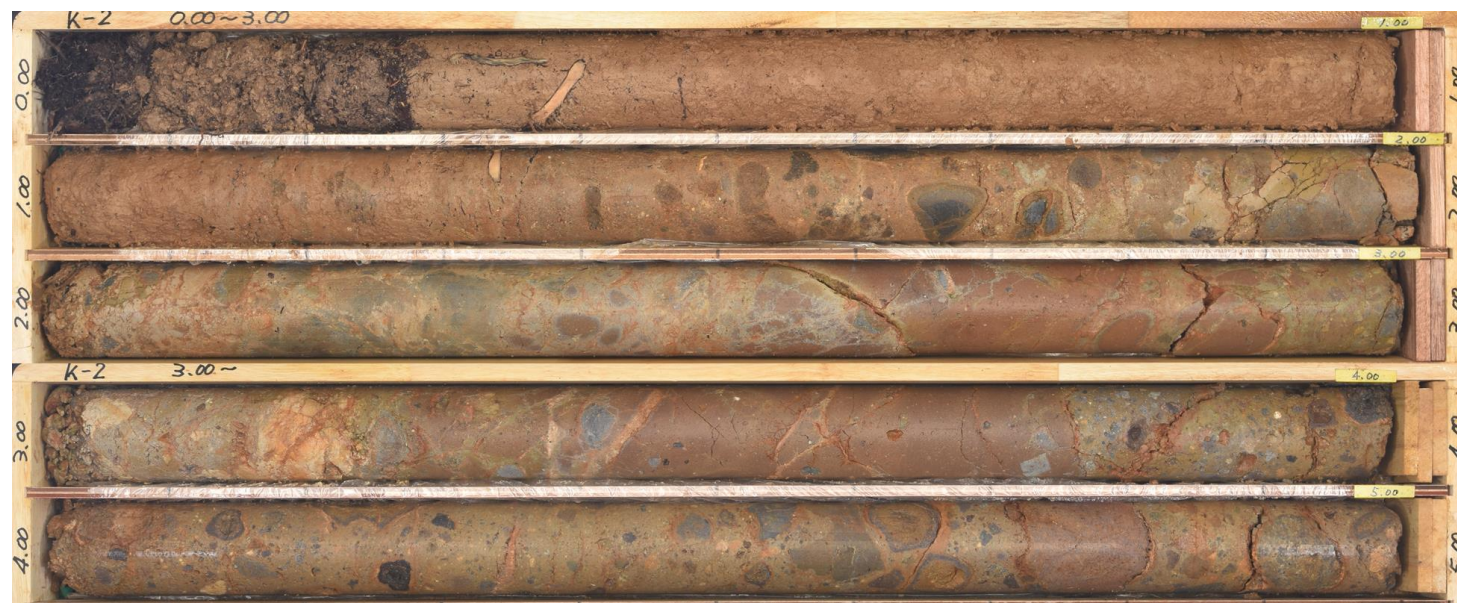
コア写真(0.0~5.0m, 掘進傾斜鉛直)
