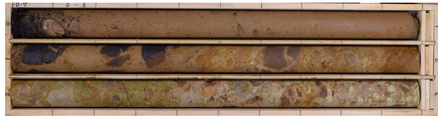
FD-7孔コア写真(0.0~3.0m, 掘進傾斜45°)
