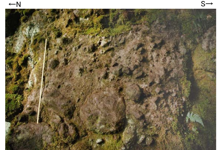
露頭写真⑤(近景) 凝灰角礫岩からなる スケールは1m
