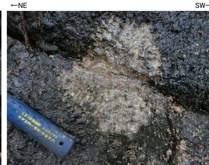
露頭写真(拡大②) 割れ目はおおむね密着し、周囲は固結しており破碎は認められない
