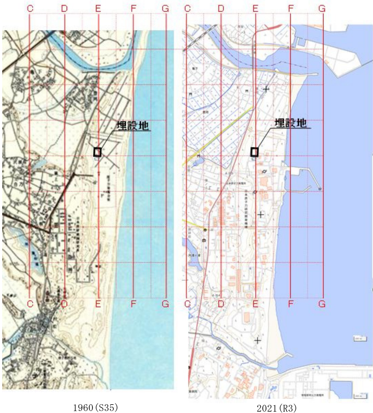
第 22 図 国土地理院地形図による廃棄物埋設地の東方の海岸線の比較
