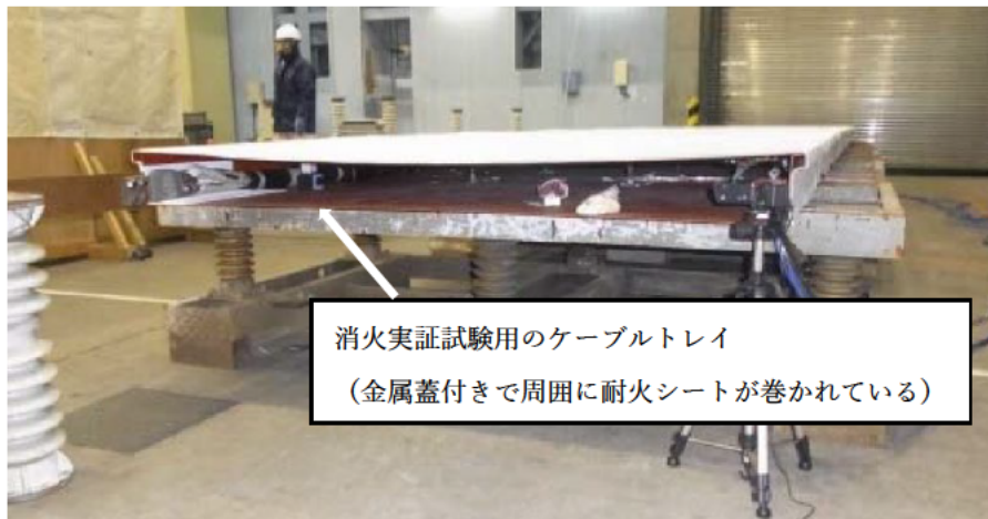
第2 図：消火実証試験用のケーブルトレイ外観
