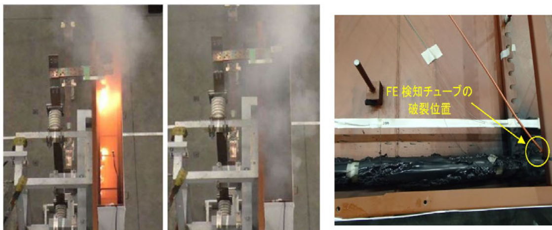
第8図：試験V1における発火・消火時の状態
