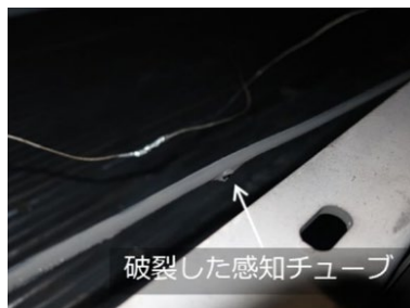
第34図 試験⑤における発火・消火時の状態
