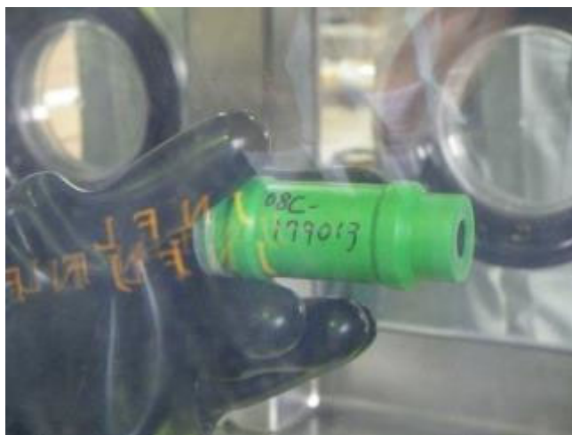
図9. 難燃性パネルを通した文字の識別
