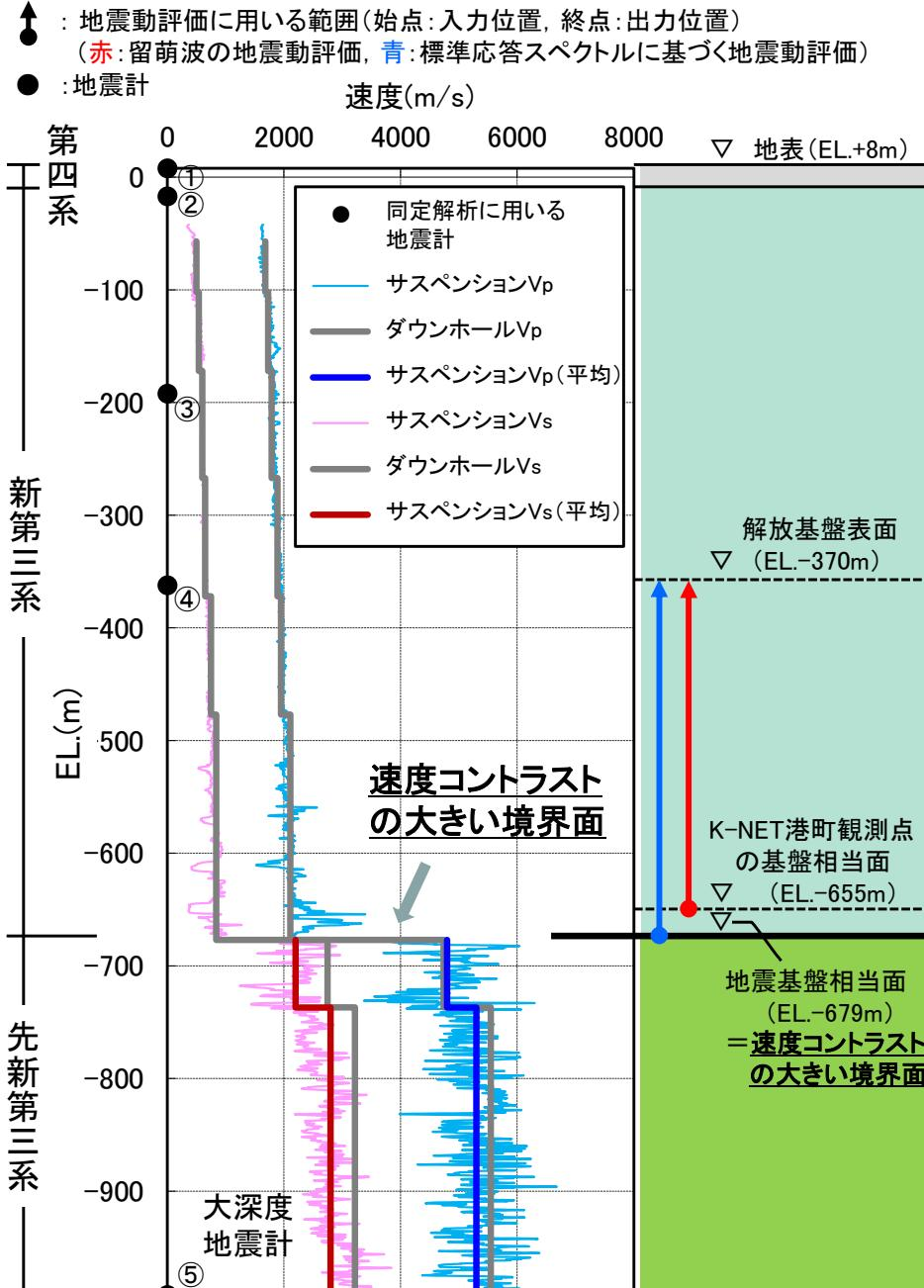
大深度ボーリングのPS検層結果の例及び地盤モデルの検討イメージ
