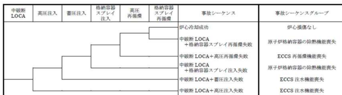
第 3.1.1.d-1 (b) 図 中破断 LOCA イベントツリー
