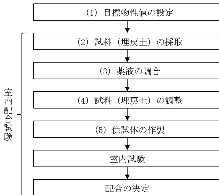
図 4.5.1-1 室内配合試験におけるフロー
