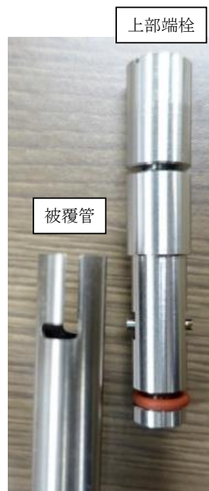
図 1 燃料試料挿入管（試作品）の上部外観
