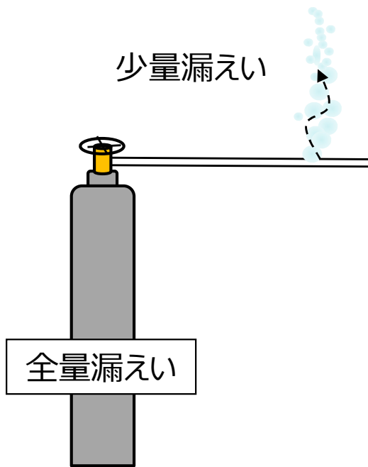
図15 ボンベ配管からの漏えい
