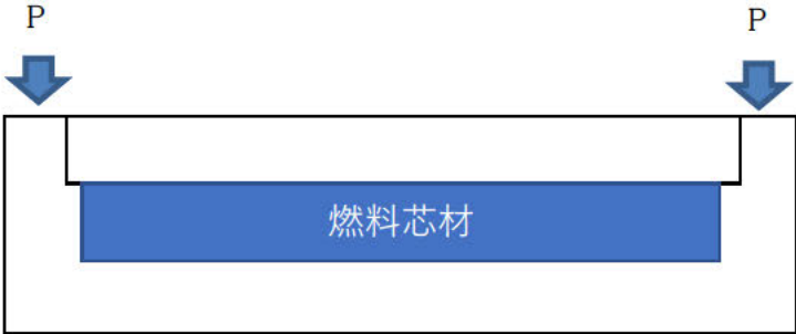
图 2 燃料要素构造 (断面图)
