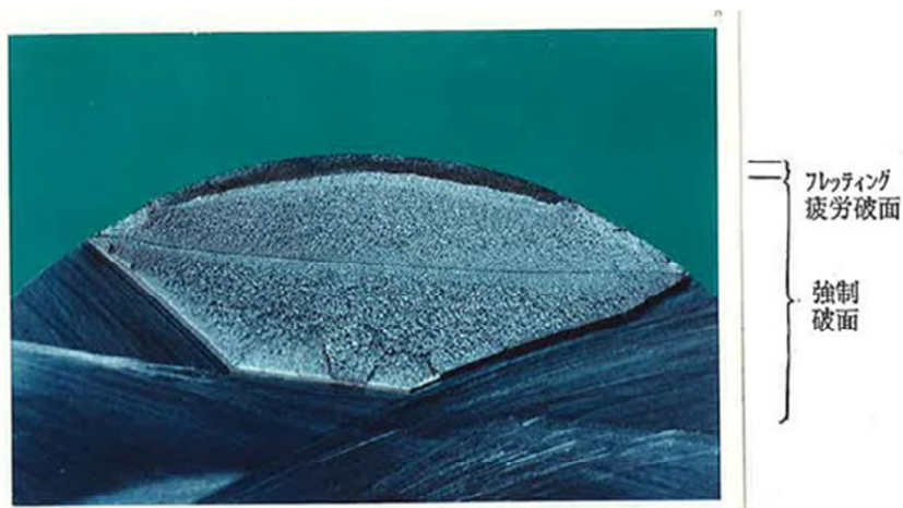
図7 フレット疲労破面例
