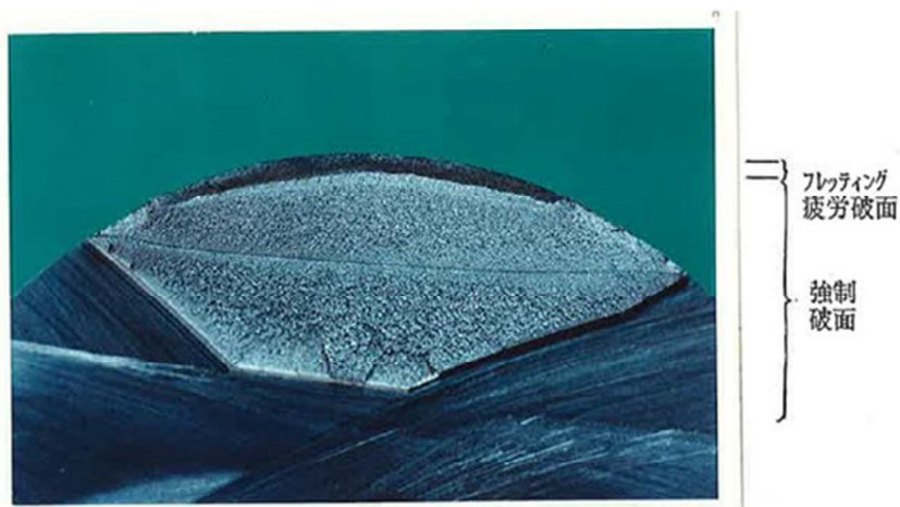
図7 フレット疲労破面例
